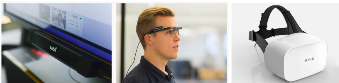
Figura 5.8: Rastreamento ocular de plataforma, com óculos simples, e com óculos especial de realidade virtual
